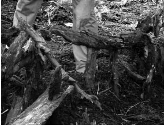
Gambar 1. Akar tanaman yang menggantung di atas permukaan tanah merupakan bukti adanya subsiden gambut
