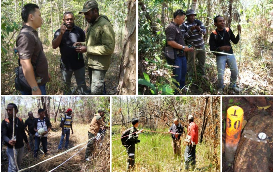
Gambar 13. Kegiatan pembuatan plot permanen di Taman Nasional Wasur, Merauke dan di hutan alami di Wambena, Jayapura. Pembuatan PLOT KECIL: (A dan B) perekaman geposisi titik ikat menggunakan GPS dan menentukan arah utara menggunakan kompas, (C dan D) pengukuran PLOT KECIL 5 m x 40 m dan pembuatan siku PLOT KECIL, (E) tanda titik ikat dari plot permanen (Foto: Isak Ormuseray dan Universitas Brawijaya/Kurniatun Hairiah)
