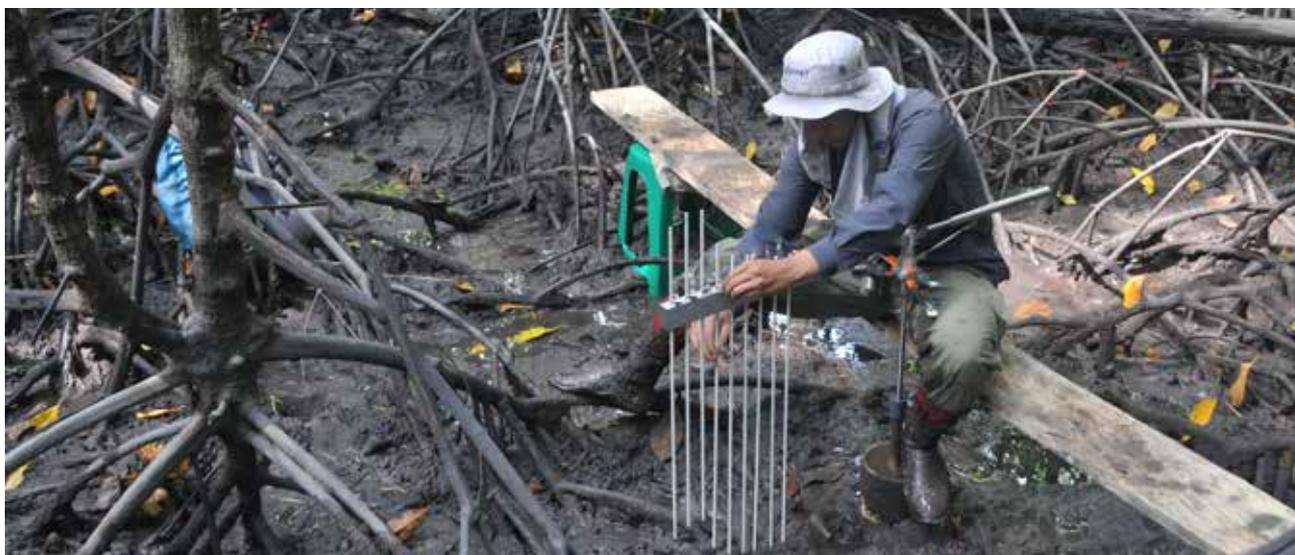
Mengukur laju sedimentasi di mangrove menggunakan Rod Surface Elevation Table (RSET) di Bintuni, Papua
