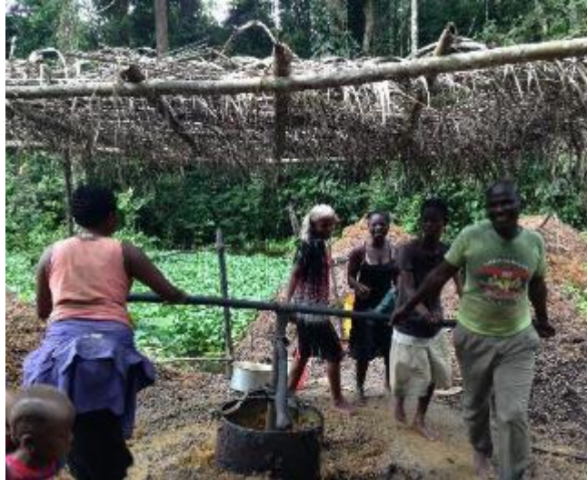
Figure 11 : Pressage artisanal des noix de palme pour la production d'huile dans le village de Yaosenge (Photo : Péroches, 2020)
