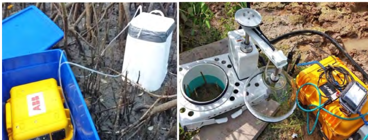
Figura 6.3. A) Analizador de gases (“campanas de gases”) para \text{CH}_4 (LGR-ICOS™ GLA131-GGA) y B) Cámara de medición de \text{CO}_2 (IRGA) Fotos: Julio Salas.
