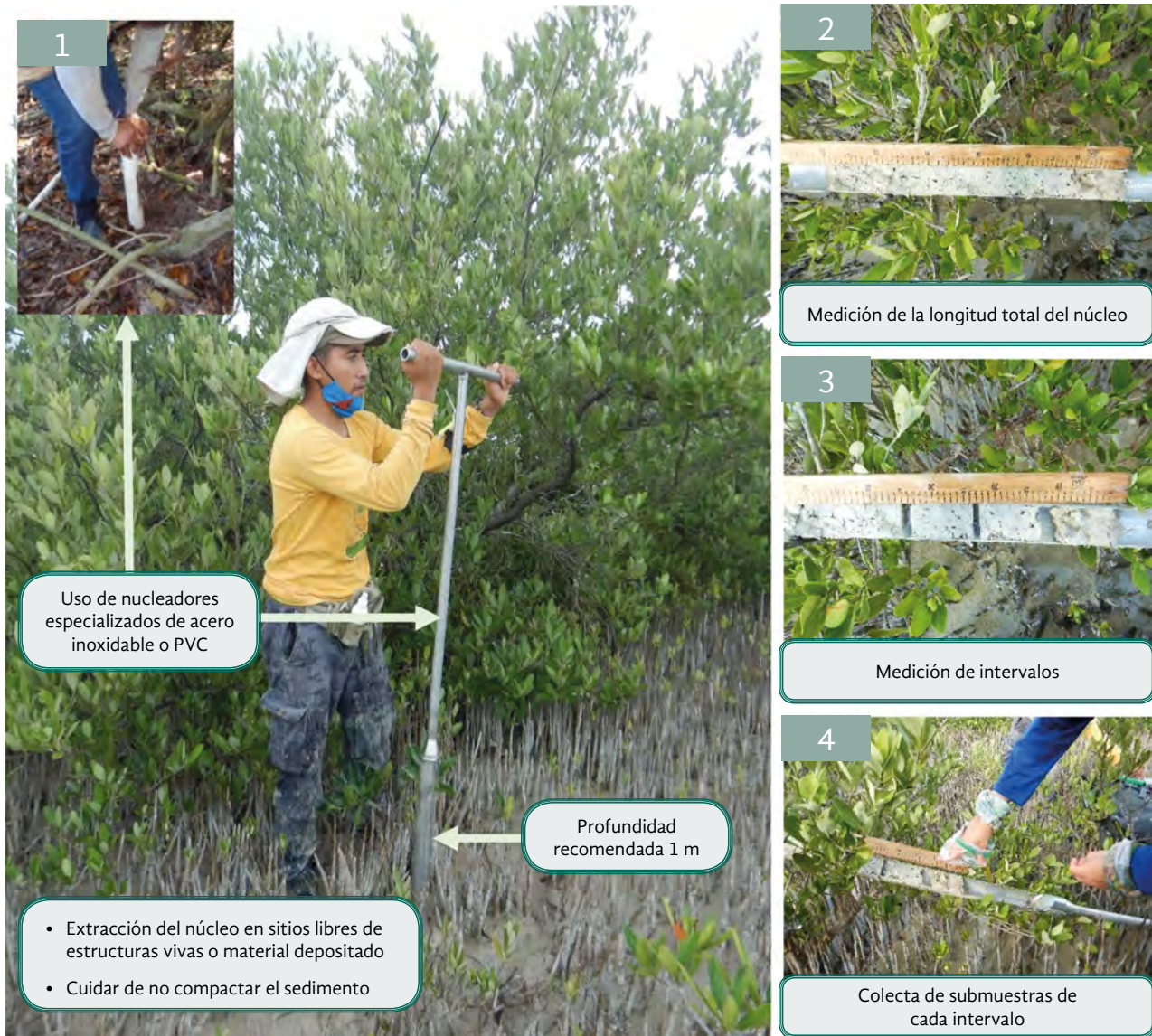
Figura 4.15. Metodología para la extracción de núcleo de suelo y la colecta de muestras para la estimación del carbono orgánico del suelo.
