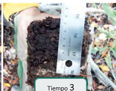
Figura 4.17. Esquematización del método de marcadores de feldespato y metodología para la medición de acreción de suelo en Manglar. Diseño: Diana Cisneros de la Cruz, Ilustración: Alberto Guerra.
