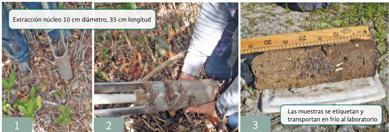
Figura 4.12. Extracción de núcleos para la estimación de biomasa viva subterránea.
