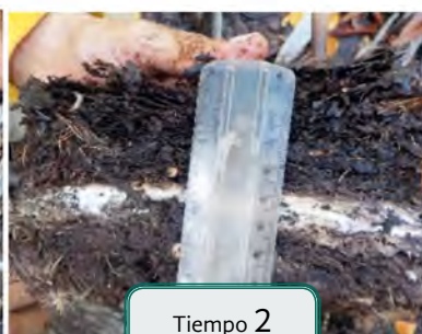
Figura 4.17. Esquematización del método de marcadores de feldespato y metodología para la medición de acreción de suelo en Manglar. Diseño: Diana Cisneros de la Cruz, Ilustración: Alberto Guerra.
