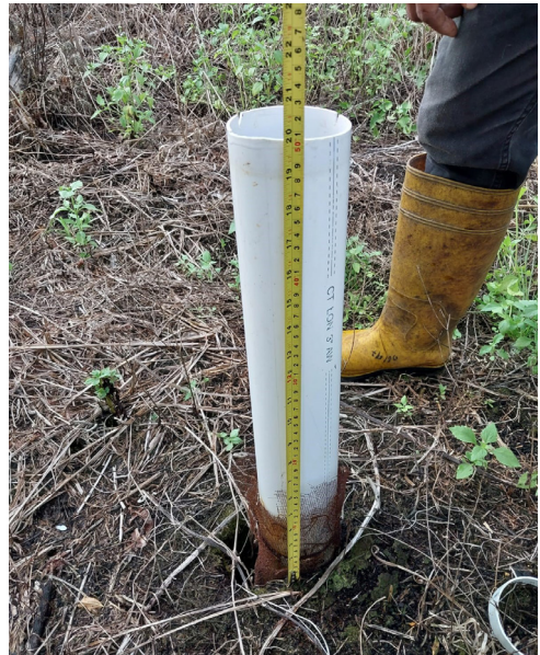
Gambar 12.5 Sumur pantau untuk pengamatan tinggi muka air tanah gambut
