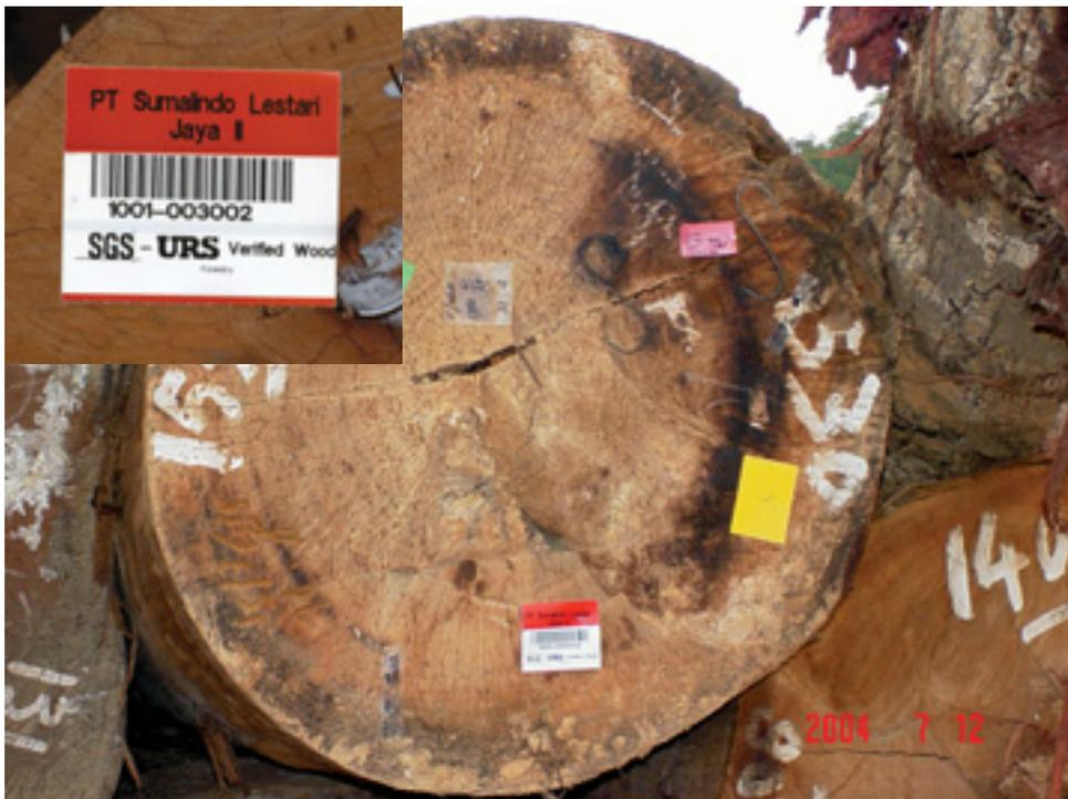
Barcoding yang digunakan untuk menguji Lacak Balak untuk log dari HPH ke industri pengolahan kayu. (Foto oleh Yudi Iskandarsyah)
