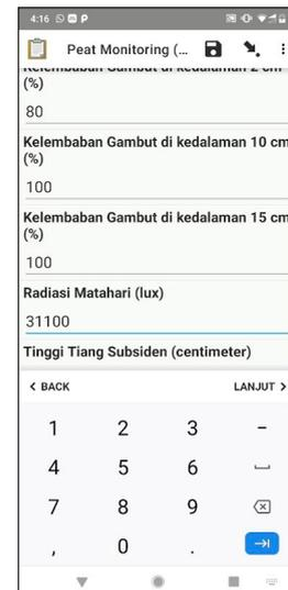
9. Pengukuran **Tinggi Tiang Subsiden** dilakukan menggunakan pita ukur. Pengukuran ini dilakukan dengan mengukur tinggi dari ujung tiang hingga permukaan tanah. Pengukuran Tinggi Tiang Subsiden dilakukan dengan tenggang waktu yang lebih panjang dibandingkan dengan parameter lain, mengingat laju subsiden yang rendah. Setelah selesai, lanjutkan ke halaman berikutnya dengan memilih tombol **Lanjut**.
