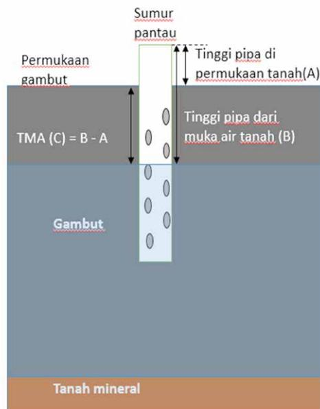
**Gambar 4.22** Penampang sumur pantau yang dipasang pada arena-arena aksi di lahan gambut Desa Dompas.
