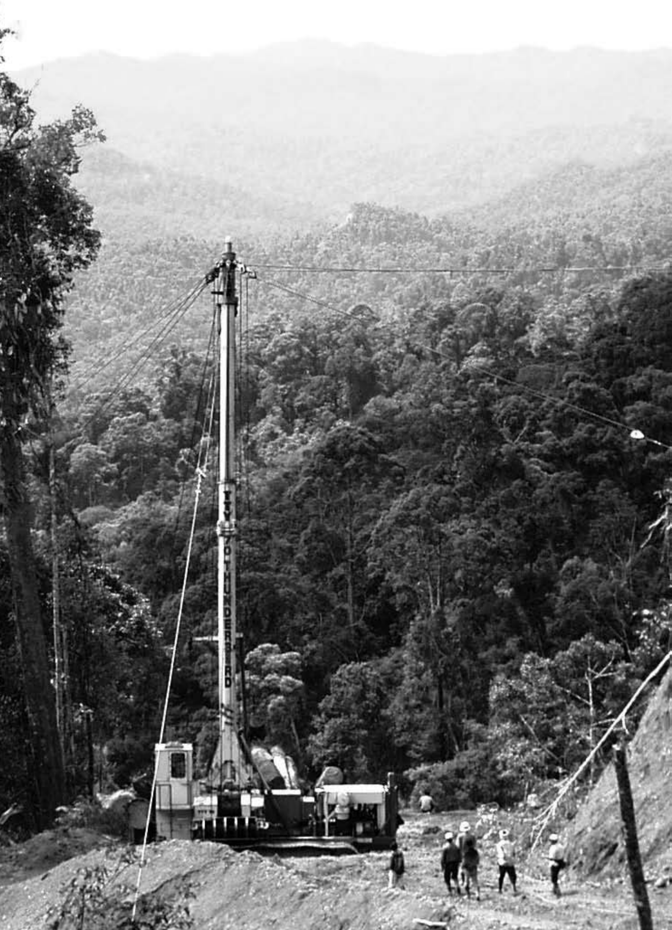
Pemanenan hutan dengan menggunakan skyline (Foto oleh Agung Prasetyo)
