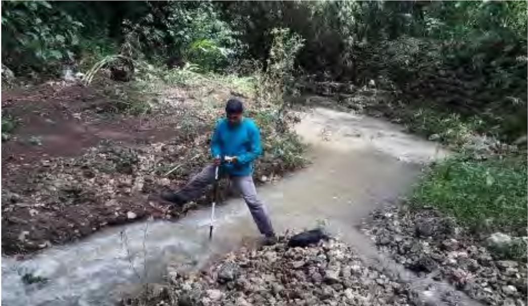
**Gambar 14.** Pengukuran debit Sungai Bribin Hulu menggunakan *current meter*, lokasi di jembatan Bolodukuh
