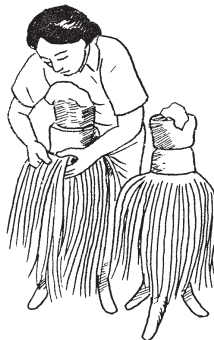
Las toquilleras permanecen de pie mientras tejen, apoyándose en una horma cilíndrica de madera.
