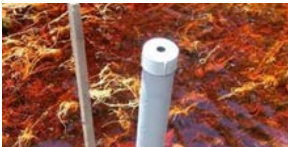
Gambar 3. Pengukuran tinggi muka air di Taman Nasional Sebangau
