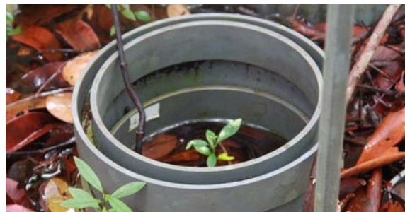
Gambar 4. Pengukuran tinggi muka air di Laboratorium alam gambut
