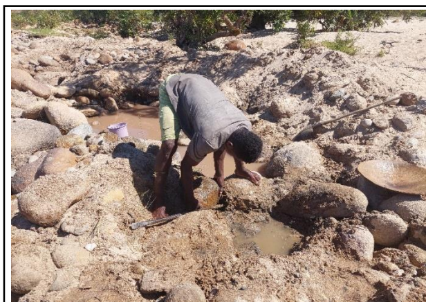
Figure 8: Extraction des terres à tamiser sur le lit du fleuve Mahavavy , en période d'abaissement du niveau de l'eau.
